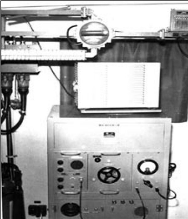
Högspänningsdelen till radarn.
