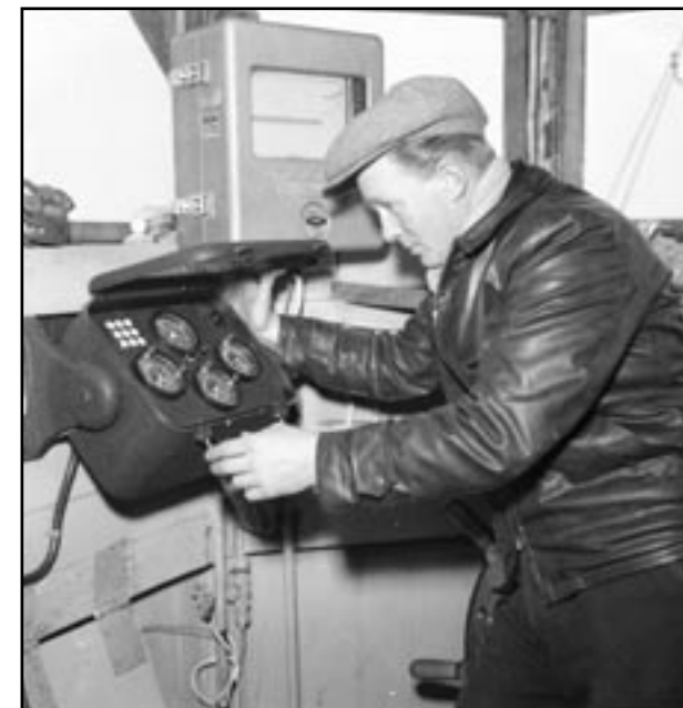
Decca utrustning ombord. Positionen angavs med tre parametrar
