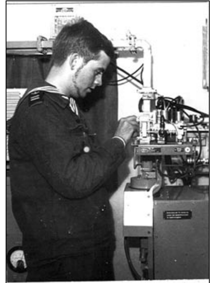
Teknikern justerar på högspännings-delen.
