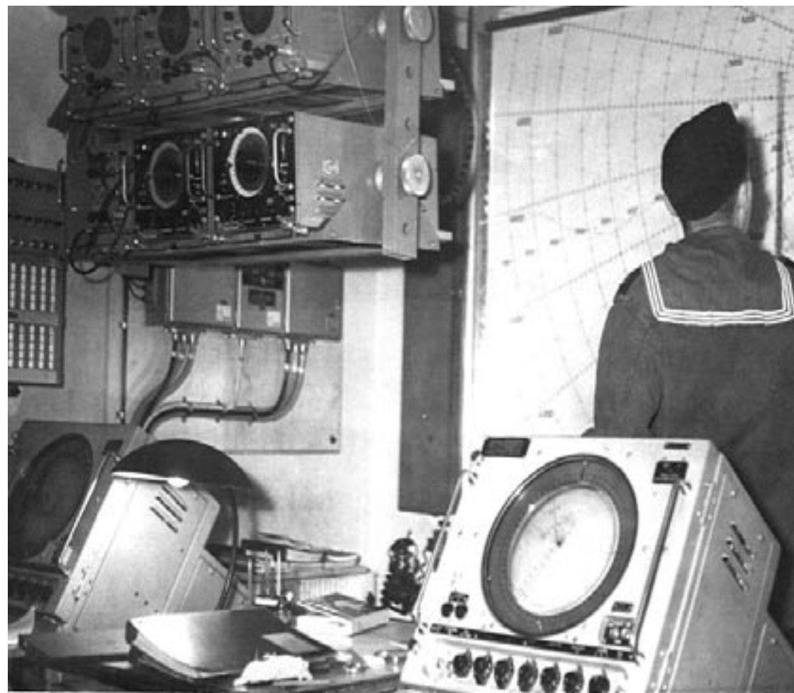
Interiörbild från operatörssrummet med PPI:er och plottingbord på väggen.
