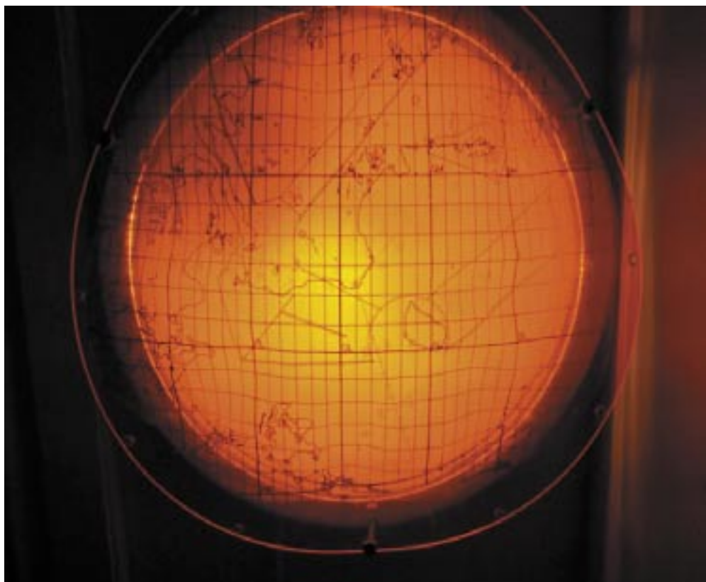
Bild av PPI med inlagd karta Foto taget med Leica kameran av PPI som visar södra Östersjön. Det var en imponerande auktionsradie på radarn. Betänk att det är teknisk nivå 50-tal.
