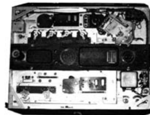
SM-enhet med luckorna öppnade. Den komplexa mekaniken syns här. "Staven" längst till vänster i mittdelen är en konst-antenn, en glödlampa som användes vid trimning.
