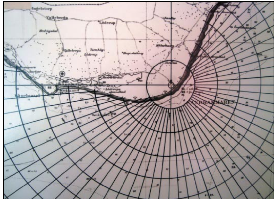
Radar plottingbord placerat på väggen i fyrens maskinrum vid radarns PPI
