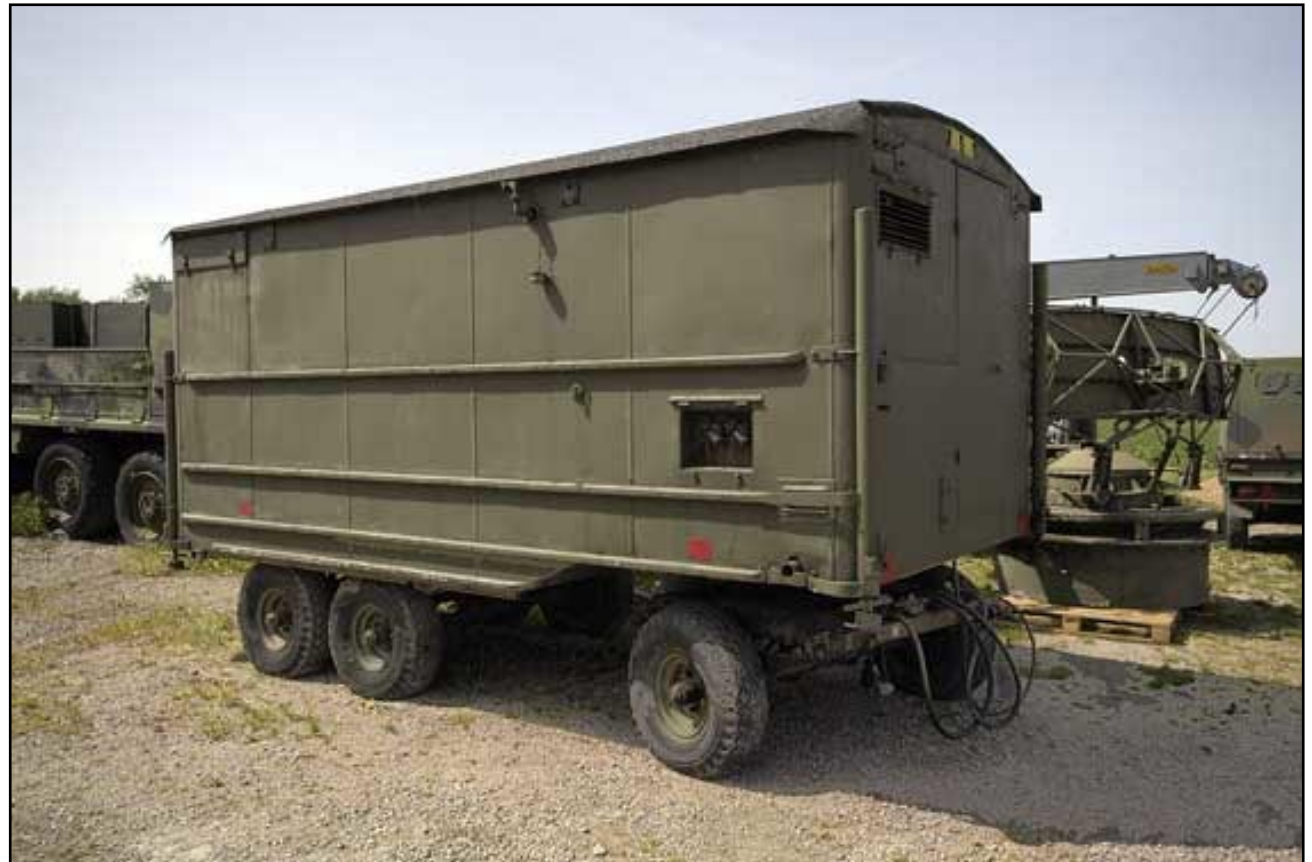
Radarvagn till KSRR station. För att snabbt komma igång med de olika KSRR stationerna efter beslutet installerade man radaranläggningarna i vagnar istället för att invänta att bygga en bunker för radarn.
