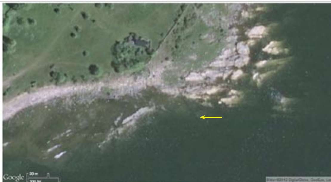
Man sprängde en ränna för kabeln där den går ut i sjön. Syns som en mörk linje på flygfotot.
